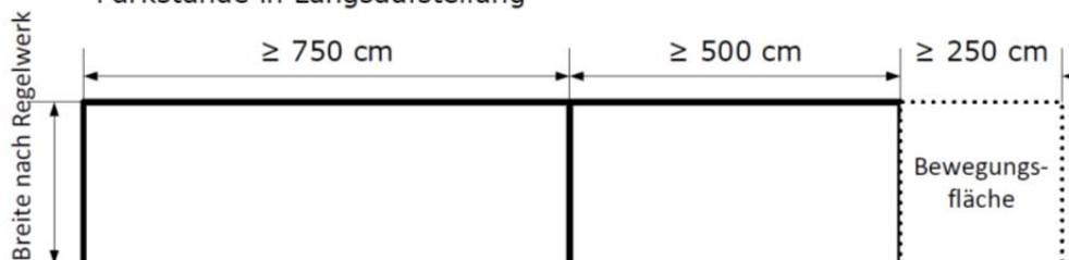
Abbildung 2: Abmessungen von Parkständen mit Heckausstieg (Draufsicht)
